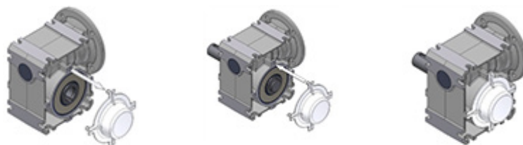
Afbeelding 15: demontage en montage van de afdekkap
