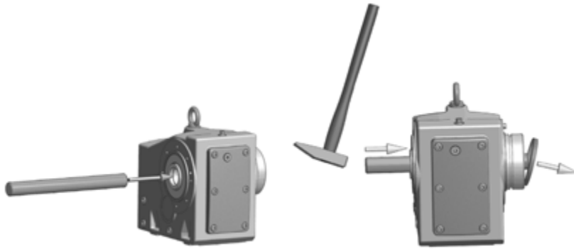
Afbeelding 7: Demontage van de af fabriek gemonteerde afsluitkap
