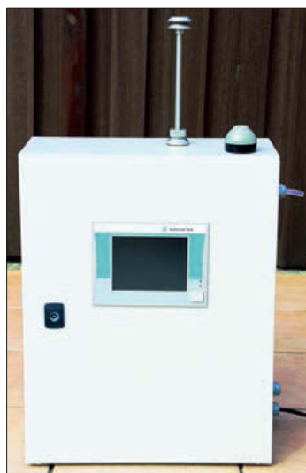
Compacte HMI (ETV0551) voor visualisatie en besturing, continue luchtinzuging en ledalarmering
