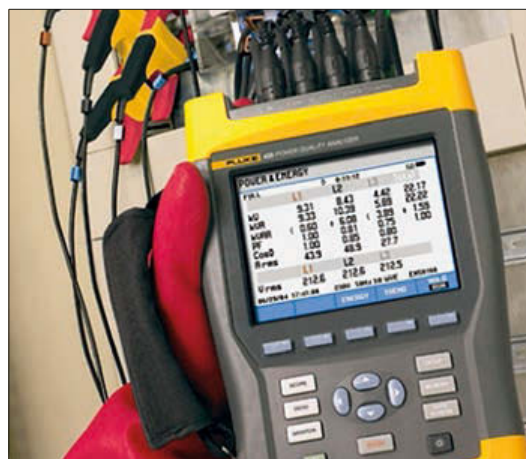
Dit toestel is geschikt voor het uitvoeren van een powerquality-analyse. Hier wordt een meting op drie fasen tegelijk uitgevoerd
