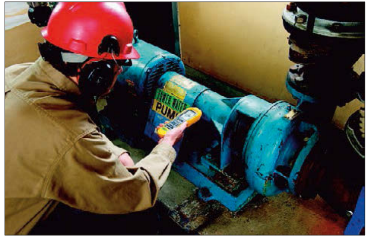
Hier is men op zoek naar trillingen en dus een onbalans in de motor. Door de motor achteraf opnieuw uit te balanceren, kan men vaak verrassend veel centen uitsparen
