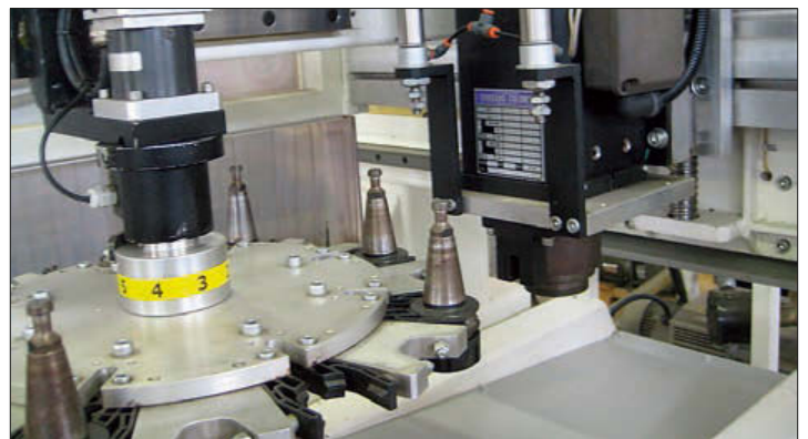
Een werkstukgrijper in actie. Snel omschakelen tussen productieseries is een conditio sine qua non voor een efficiënte productie
