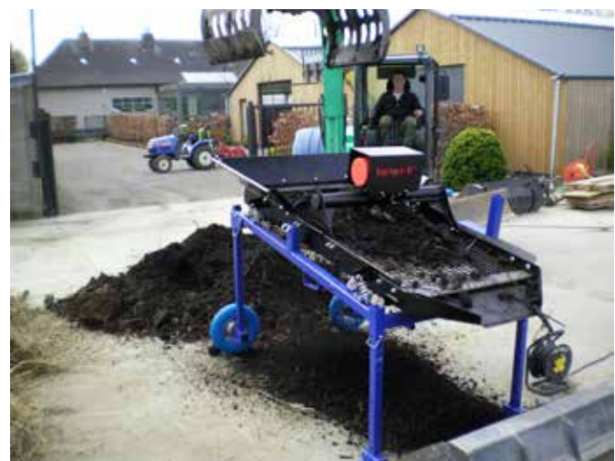
Dankzij een maasopening tot 0,5 mm kunnen er met de Mini Screener zeer specifieke materialen uitgezeefd worden.
