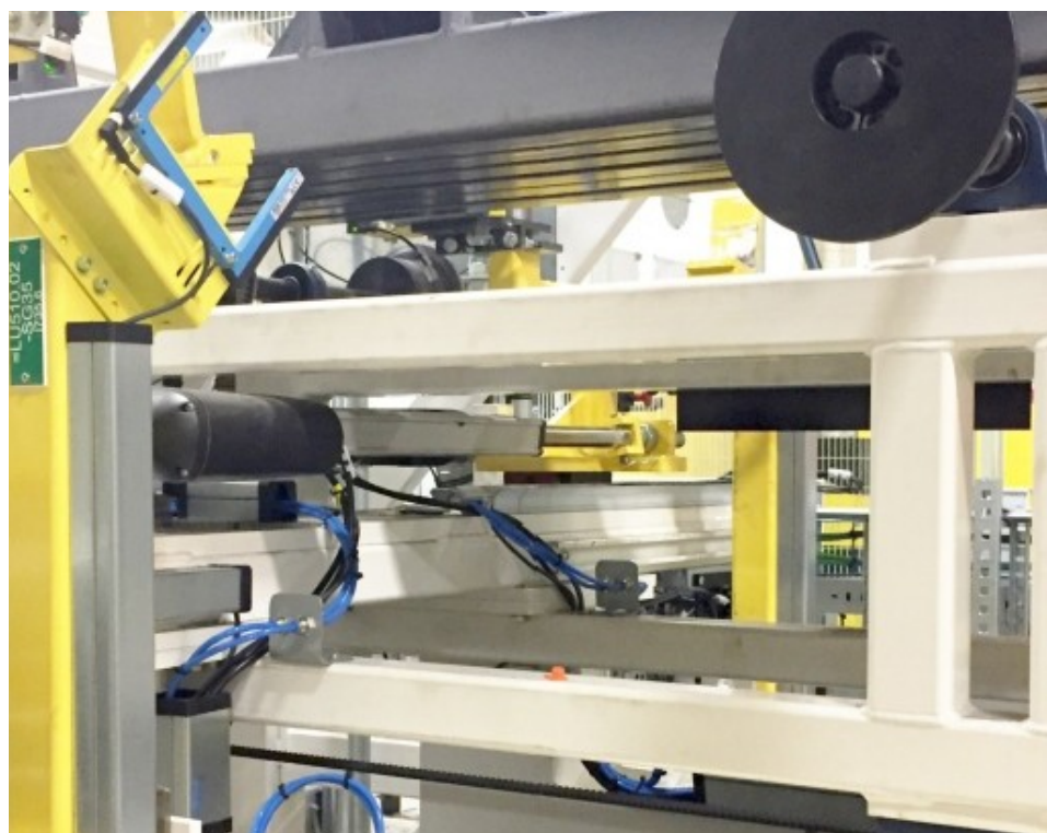
De 'lakskids' dienen als platform waarmee de wagens door de spuitafdeling getransporteerd worden
