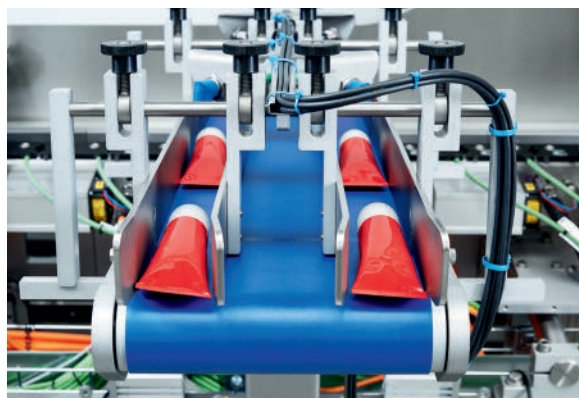
Constant laden: de servogestuurde transportbanden brengen steeds twee tubes parallel naar het laadstation van de carriers.
