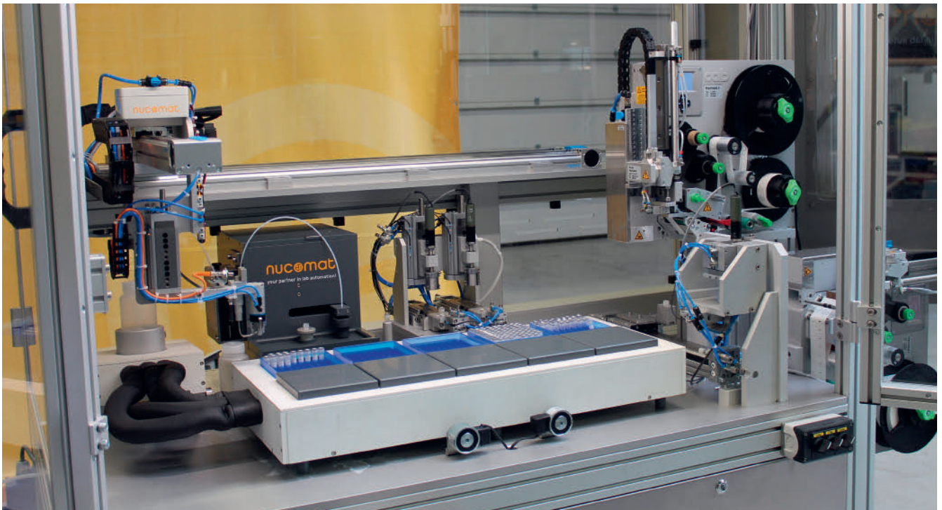
De machine in beeld: centraal de decapper met links daarvan de afvuller. Linksboven de robot.
