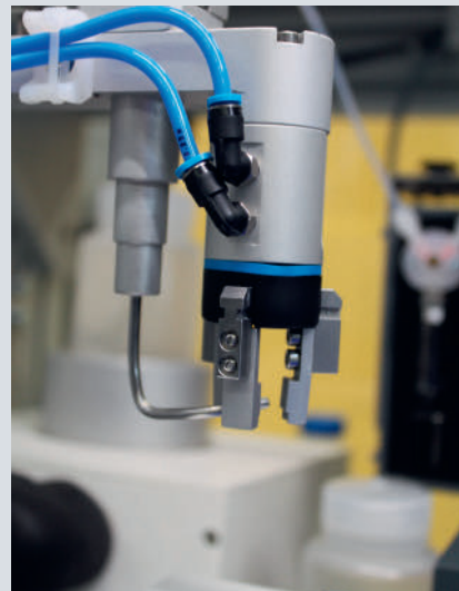
De robot haalt een capsule uit de decapper.
