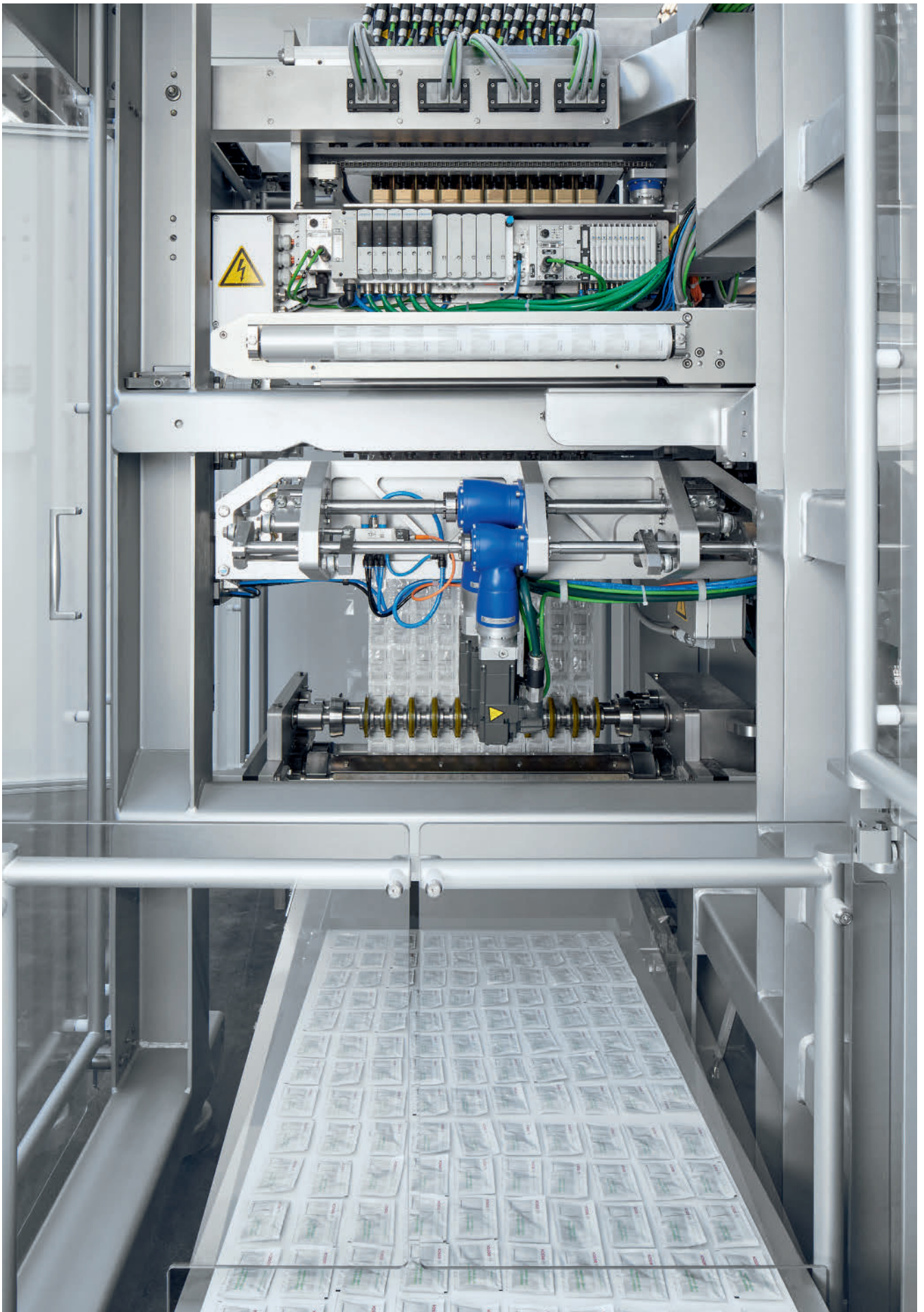
Snelle en precieze instelling van de banen met een druk op de knop: daarvoor zorgt het nieuwe automatiseringsplatform Festo Motion Terminal VTEM op de zakjesvuller Sigpack VPF van Bosch Packaging.
