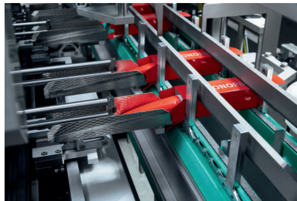
Kritieke passage: in deze zone zijn het MCS-systeem en de kartonneerinstallatie gesynchroniseerd. In de laatste zone gebeurt het inschuiven in de doosjes.
