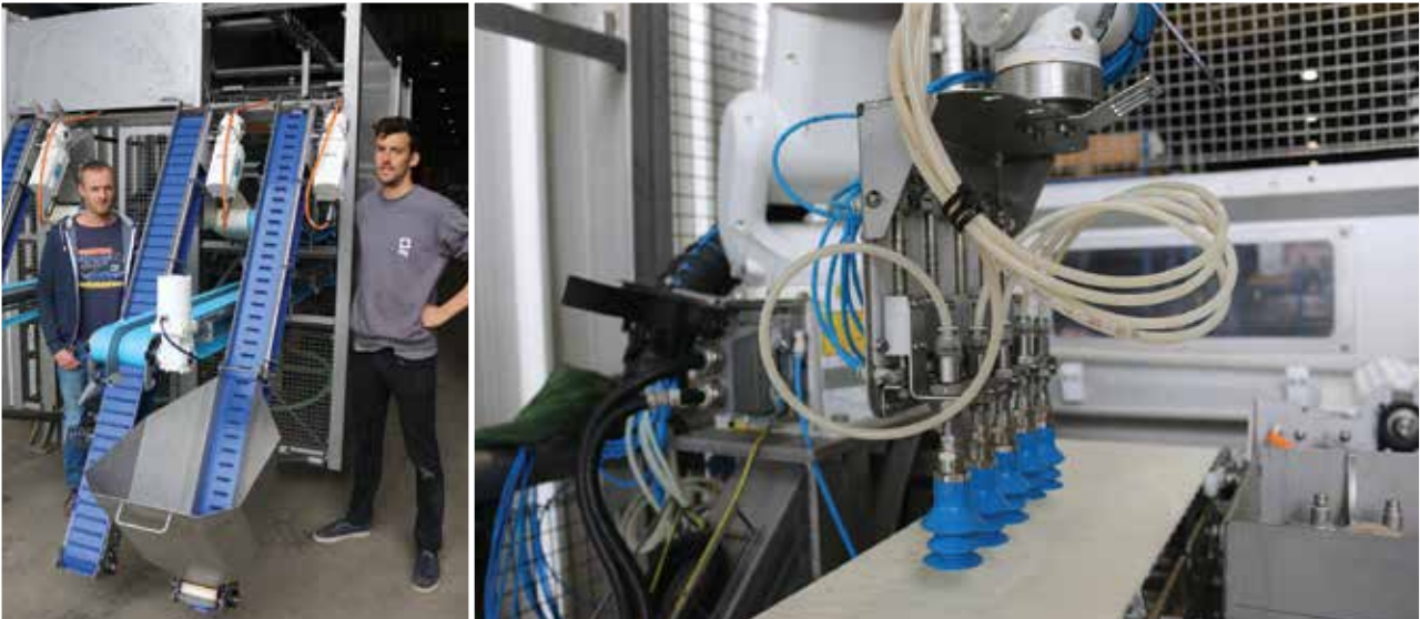
De pick & place unit met FANUC robotarm doet het voorbereidende werk en zal alle stukjes - vleesblokjes, ajuin en paprika - van de saté sorteren.
