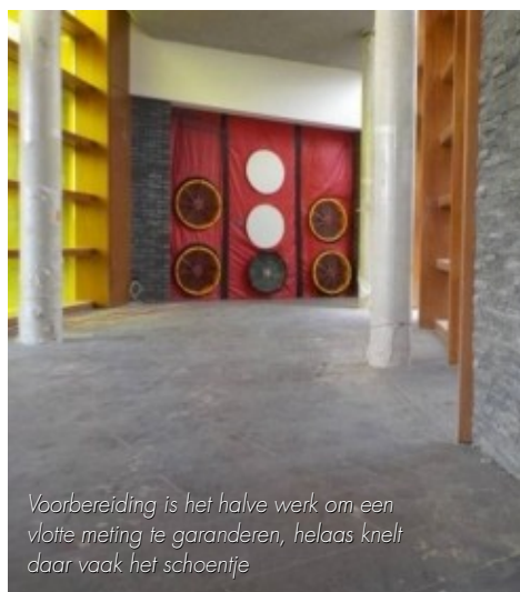
Vaak wordt door de opdrachtgever een luchtdichtheidsklasse geëist waaraan de ventilatie moet voldoen, het is dus zaak om de lekverliezen te beperken
